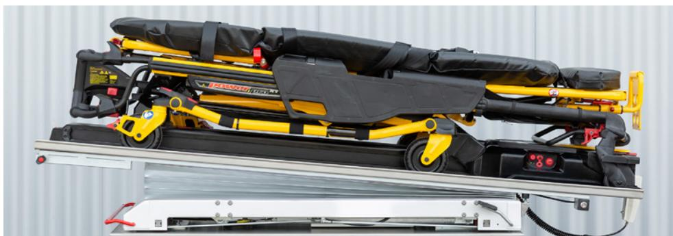
Über den Taster „**Kopf tief**“ wird die Beladeplattform hydraulisch auf die gewünschte Position mit abgesenkter Kopfseite gefahren.
