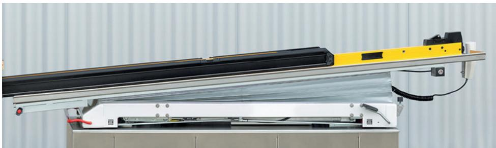
Über den Taster **„Kopf hoch“** wird die Beladepattform hydraulisch auf die gewünschte Antischock- bzw. Be- und Entladehöhe gefahren.
