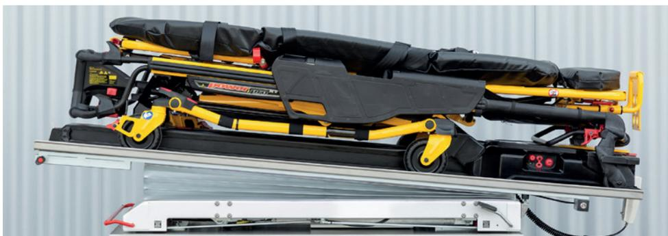
Über den Taster **„Kopf tief“** wird die Beladepattform hydraulisch auf die gewünschte Schockstellung gefahren.
