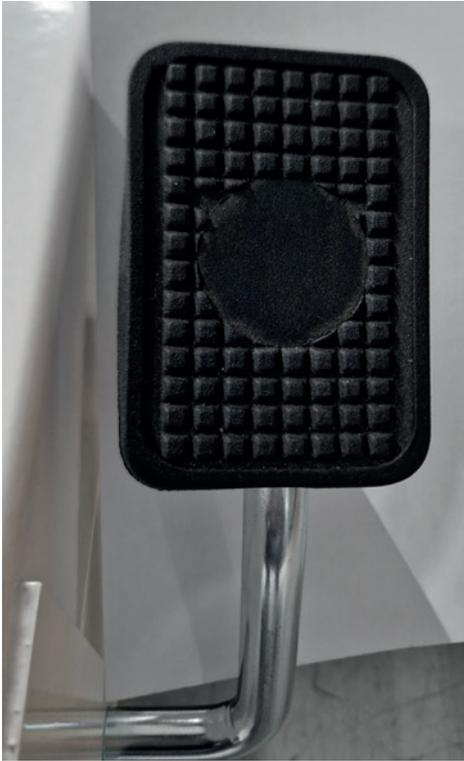
Eine Querverschiebung ermöglicht ein seitliches Verschieben im Fahrzeug (schwarzes Fußpedal). Mehrere Rasterungen sind vorhanden.
